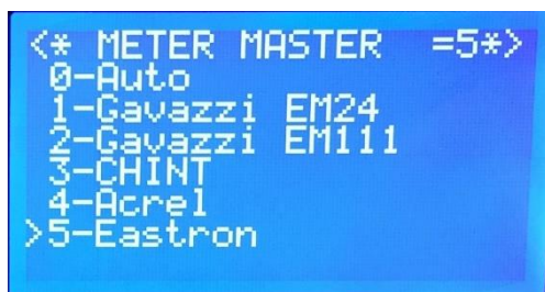
Figura 22 - Settare il parametro METER MASTER=5-Eastron
